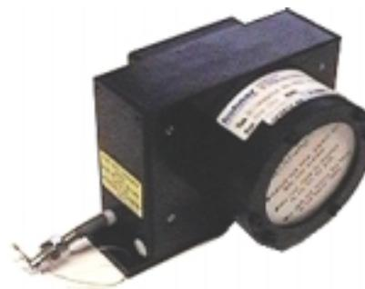
Beim Seilzug SGI wird die beim Abwickeln erzeugte Drehbewegung der Seiltrommel auf einen Inkrementalgeber übertragen. Die Geber-impulse können von einer Meßanzeige oder einer Steuerung ausgewertet werden.
